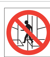
86-1040 Prohibido pasar, andamio incompleto
