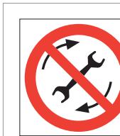
86-1047 Prohibido reparar en funcionamiento
