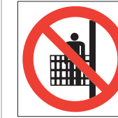
86-1038 Montacargas prohibido a personas
