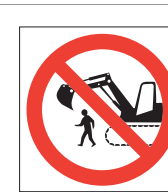
86-1043 Prohibido permanecer en el radio de acción de la máquina
